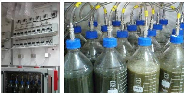
Figura 3. Detalle de planta piloto empleada para evaluar el potencial de biometanización de sustratos.
